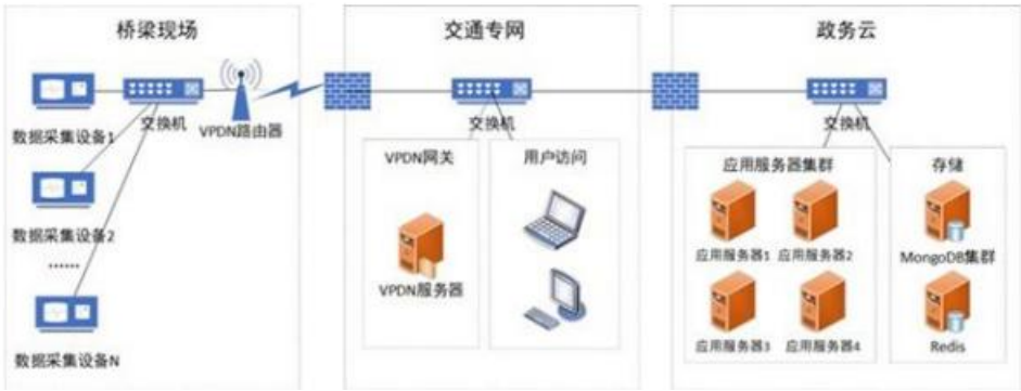
图 6.1-1 数据采集与传输子系统架构
